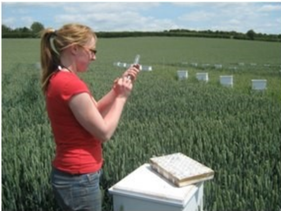
Figur 1. Målekammer i en forsøgsmark. Den anvendte metode adskiller sig ikke fra den måleteknik, der sædvanligvis anvendes i Danmark. Fra: " Agricultural Greenhouse Gas Inventory Research Platform ".
